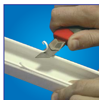
Стружка подтверждает высокое качество материала
